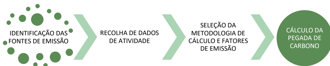
Figura 4 - Etapas associadas ao cálculo da pegada de carbono mediante a identificação das fontes de emissão
